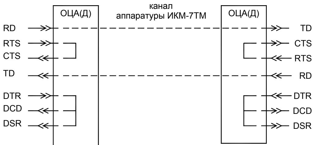
Рисунок 5 – «Непрозрачный» режим канала RS-232
