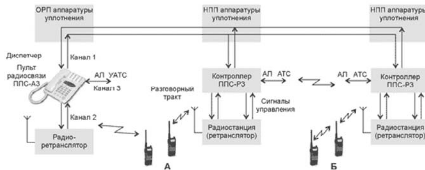
Рисунок 4.6 – Организация радиокабельной системы по каналам аппаратуры уплотнения
