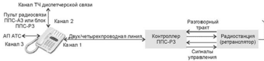
Рисунок 4.5 – Организация радиосвязи при удаленном расположении антенны
